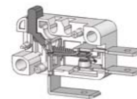
Anwendung von Kontakt-Profildraht als Schaltkontakt in einem Mikro-Schalter
