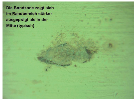
Abb. 9: Bondfläche 38 µm Draht, geätzt, 500fach
