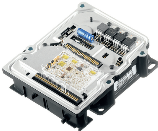
Abb. 1: Hybridbauteil mit Bondverbindungen (Foto: Bosch)
